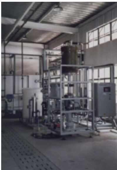
図-10 フォルクスワーゲン社における冷却液回収 VSEP 装置
